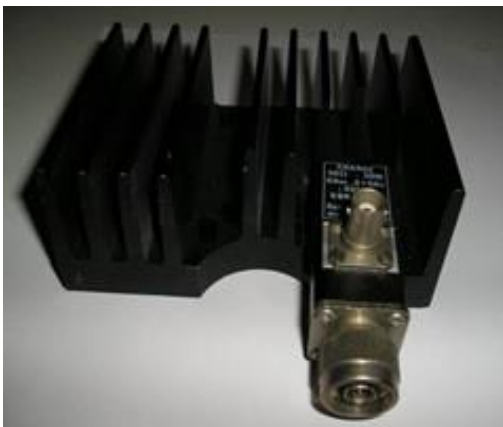
Charge 50Ω de 50W sur radiateur avec connecteur BNC pour les mesures
