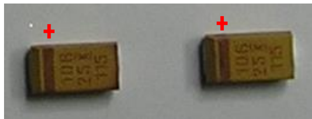
Condensateur tantale au format CMS. La connexion positive est indiquée par le trait marron.
