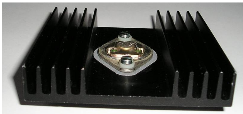
Photo d'un transistor de type TO-3 (coupé) monté sur un radiateur avec une isolation.
