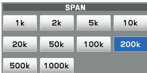
**i** Il livello di visualizzazione cambia quando si modifica SPAN, ripristinare quindi ogni volta il livello di visualizzazione ottimale con [LEVEL].
