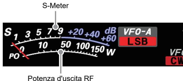
Quando si sfiora lo schermo dello strumento, viene visualizzata la schermata di selezione dello strumento di trasmissione (l'impostazione predefinita è "PO").
