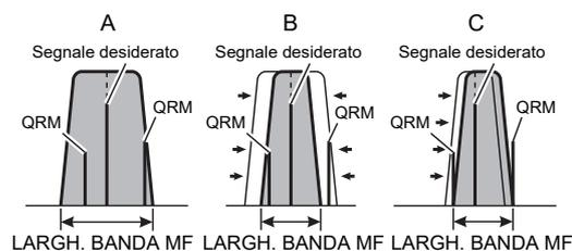
Le funzioni WIDTH e SHIFT sono gli strumenti principali da usare per ridurre in modo ottimale le interferenze. Dopo aver ristretto la banda passante (WIDTH) e/o regolato il centro della banda passante (SHIFT), il comando Contour può contribuire a migliorare ulteriormente il segnale sulla residua banda passante. Inoltre l'eventuale uso del filtro NOTCH MF (descritto più avanti), in abbinamento a questi sistemi di filtraggio, offre un importante vantaggio.
