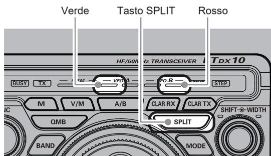
Nel funzionamento a frequenze separate, il registro VFO-A viene usato per la ricezione e il registro VFO-B per la trasmissione. Premendo nuovamente il tasto [SPLIT], il funzionamento a frequenze separate viene disattivato.
