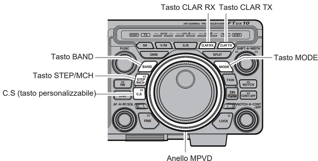
**BANDA:** Premere il tasto [BAND], quindi ruotare l'anello MPVD per commutare la banda della frequenza operativa.
