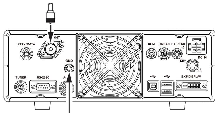
Per prevenire possibili danni provocati da fulmini, scariche elettriche atmosferiche, scariche elettriche, ecc. è necessario prevedere una messa a terra efficace. Utilizzare una calza spessa e corta per collegare la stazione radio all'asta di messa a terra piantata nel terreno (o ad un sistema di massa alternativo).
