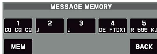
4. Sfiorare un tasto da [1] a [5], a seconda del messaggio del registro memoria PSK che si desidera trasmettere. Il messaggio programmato verrà trasmesso.
