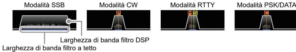
Sfiorare il display del filtro per abilitarlo e controllare il valore impostato per l'ultima funzione usata tra SHIFT, WIDTH, NOTCH, CONTOUR e APF. È possibile modificare l'impostazione ruotando la manopola della funzione attiva.
