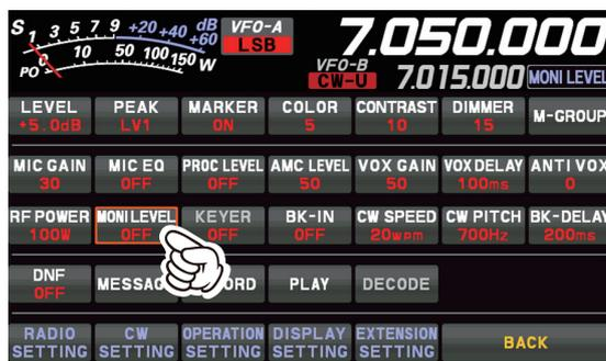
3. Ruotare la manopola [FUNC] per regolare il livello del monitoraggio.
