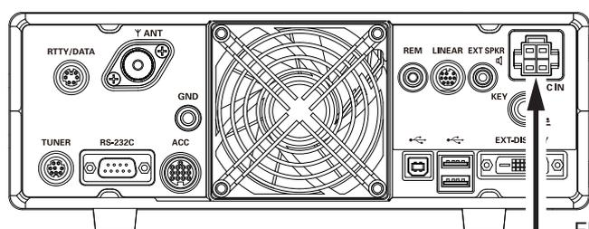
Controllare la tensione CC e la corrente nominali (+13,8 V, 25 A) dell'alimentazione prima di procedere al collegamento al ricetrasmittitore.
