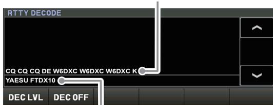
Visualizza il testo inserito nella memoria di trasmissione RTTY.
