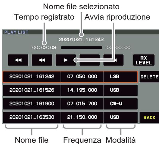
5. Ruotare la manopola [FUNC] durante la riproduzione per regolare il volume. Il volume può anche essere regolato sfiorando [RX LEVEL] e ruotando la manopola [FUNC] mentre non è in corso la riproduzione.
