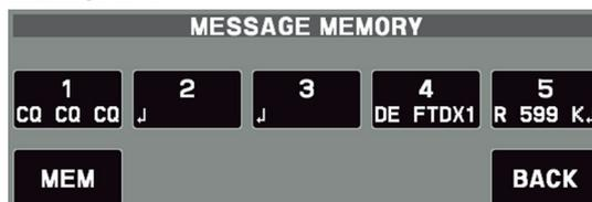
4. Sfiore un tasto da [1] a [5], a seconda del messaggio del registro memoria RTTY che si desidera trasmettere. Il messaggio programmato verrà trasmesso.
