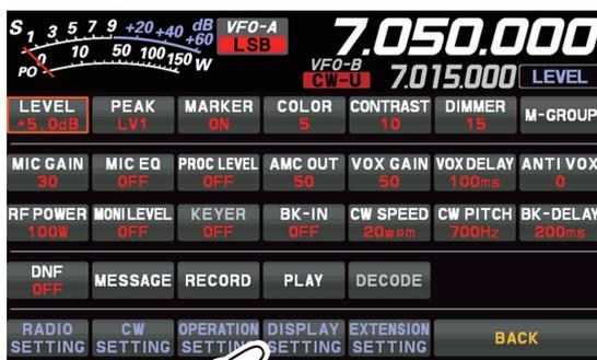
3. Sfiocare [DISPLAY] → [LED DIMMER] o ruotare la manopola [FUNC] per selezionare un'opzione, quindi premere la manopola [FUNC].
