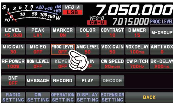
4. Sfiore l'area dello strumento sul display per selezionare lo strumento "COMP". Lo strumento "COMP" diventa lo strumento di trasmissione.
