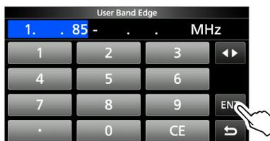
5. Introduzca la frecuencia del borde de banda superior y, a continuación, toque [ENT]. (Ejemplo: 1,95) Ejemplo de entrada: [\*] [9] [5] [ENT]
