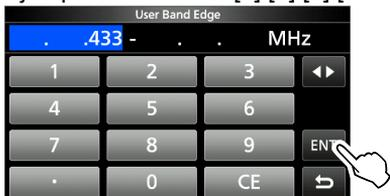
4. Introduzca la frecuencia del borde de banda superior y, a continuación, toque [ENT]. (Ejemplo: 439,9)
