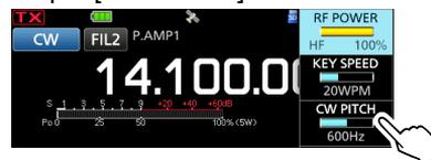
4. Gire **[MULTI]** para ajustar el tono CW entre 300 y 900 Hz (en pasos de 5 Hz).
